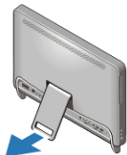
3. ábra. Hátsó állvány felszerelése
